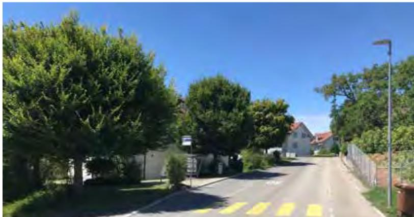
Das Projekt sieht eine Umgestaltung der heutigen Haltestelle vor. Statt der Haltestelle mit Busbucht soll eine solche mit Fahrbahnhalt und einem niveaugleichen Einstieg für zwei Türen (Anschlag 22 cm über eine Länge von 9,60m) erstellt werden. Zudem soll die Erschliessung der Bushaltestelle für die Fussgänger mit einem neuen Gehweg zwischen der Strasse «Im Feld» und der Haltestelle ergänzt und verbessert werden.
